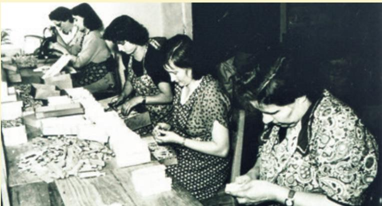
Die Modelle werden entgratet und für die Montage vorbereitet.
